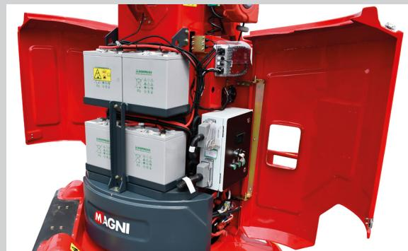
Die besonders service- und wartungsfreundliche Komponentenanordnung gewährleistet einen einfachen und schnellen Zugang bei der täglichen Wartung und bei eventuellen Reparaturen.
